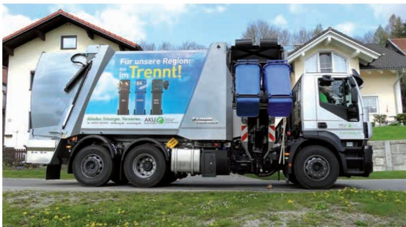
◀ Schon gewusst? Die Seitenladerfahrzeuge der AKU haben das Steuer auf der rechten Seite, damit der Fahrer das Greifen der Tonnen exakt steuern kann.
