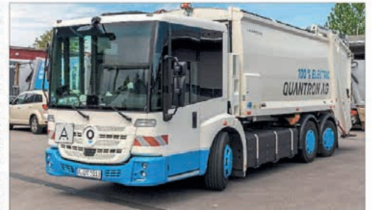
Ohne Emissionen und Geräusche unterwegs: Das ZAW testete erfolgreich ein voll elektrisches Müllfahrzeug. Foto: Walter Widberger
